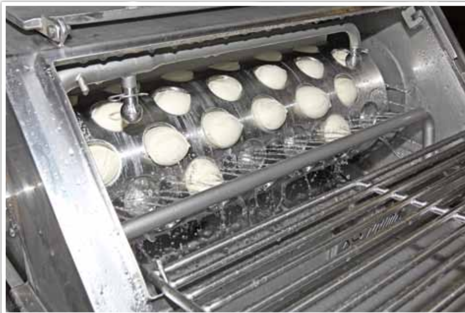
Die Formungsmaschinen Fabrikat Prima können Mozzarella-Kugeln von 96 bis 128 g Gewicht herstellen
