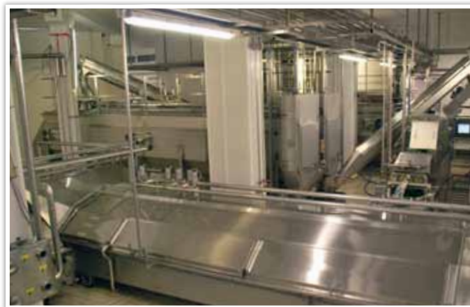
Die neue von Sulbana installierte Mozzarellaproduktion bei Jäger hat eine Leistung von 4 t/h (Foto: mi)
