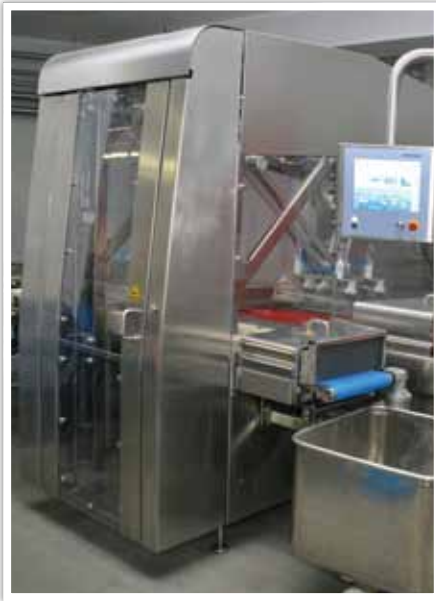
Die Käse werden auf der Multivac-Linie automatisch in tiefgezogene Folientaschen eingelegt, die dann verschlossen und geschrumpft werden (Foto: mi)
