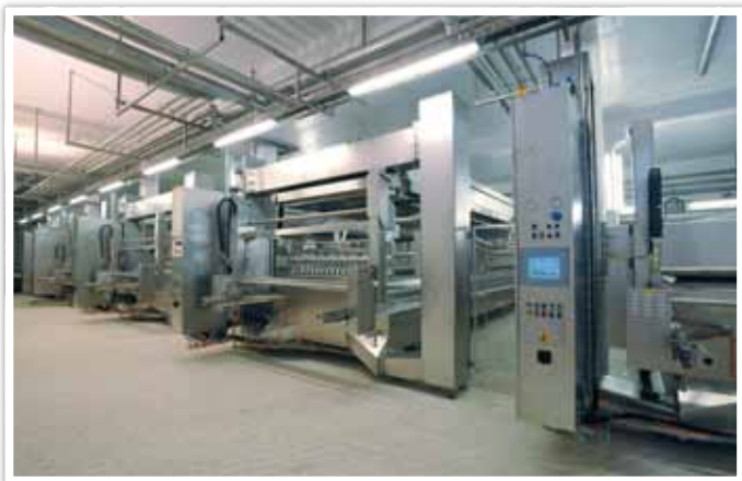
Bei den 5 von Kalt Maschinenbau gelieferten Pressen sind Abfüllen, Pressen, Ausräumen und Ausformen SPS-gesteuert, sämtliche Schritte erfolgen vollautomatisch (Foto: mi)
